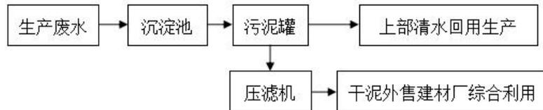
图 4-1 生产废水处理流程图
