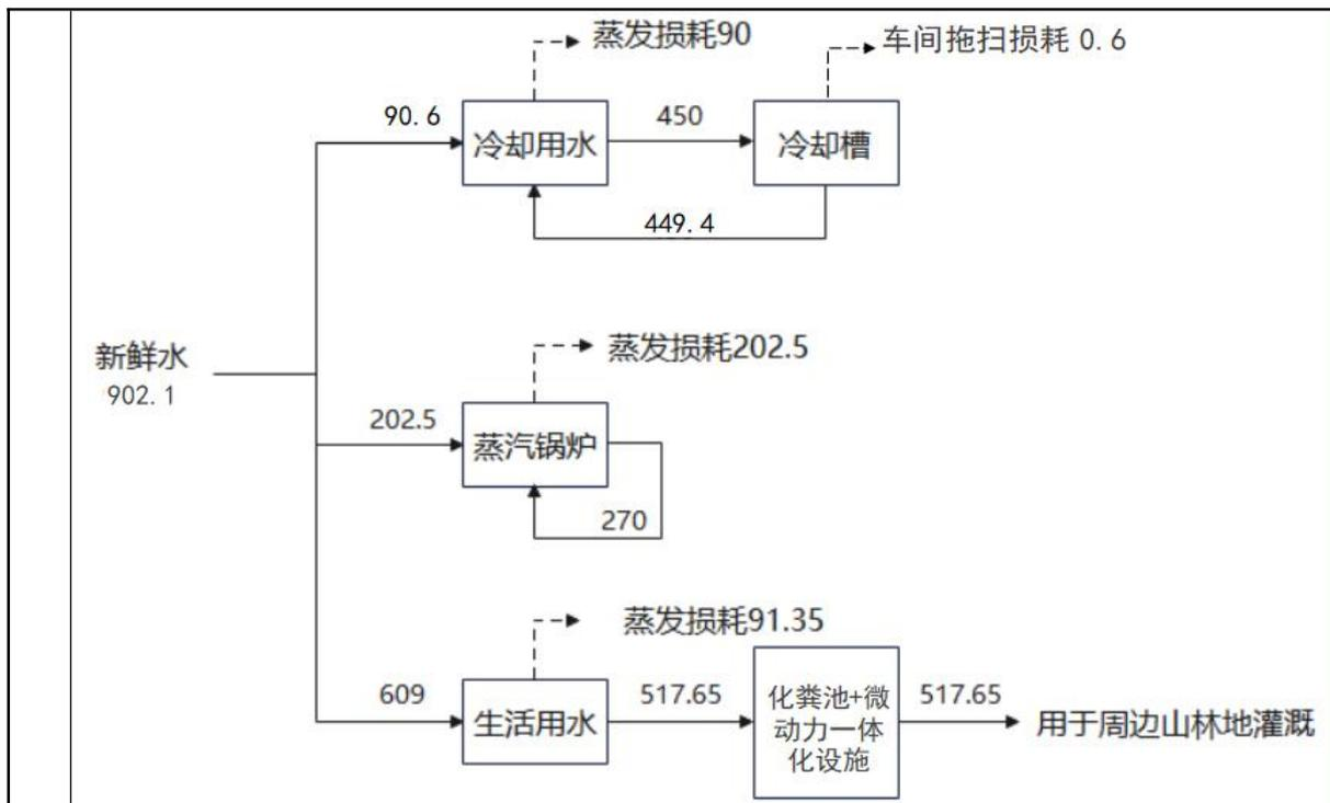
图 2-1 项目水平衡示意图 (单位: t/a)
