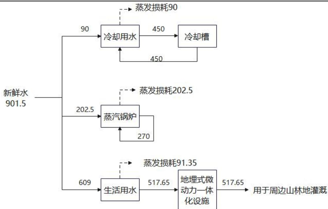
图 4.2-1 水平衡图 (单位: t/a)
