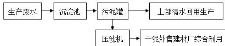
图 4-1 生产废水处理流程图
