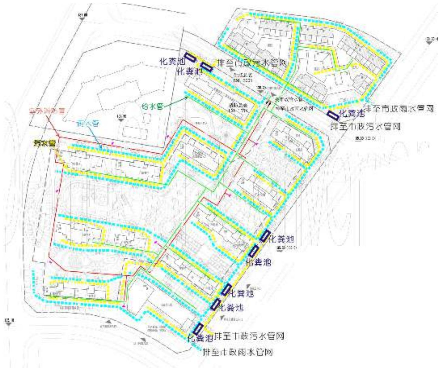
图 4.1-5 化粪池及污水接管图
